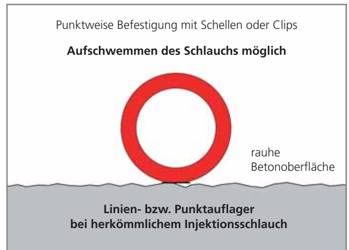
Schematischer Querschnitt herkömmlicher Injektionsschläuche
