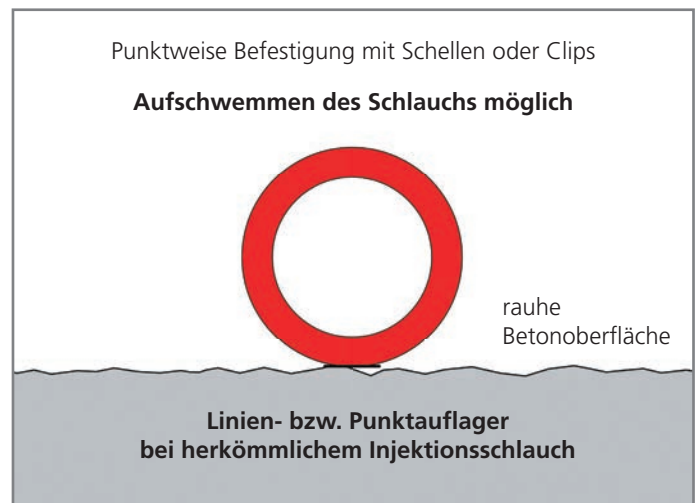
Schematischer Querschnitt herkömmlicher Injektionsschläuche
